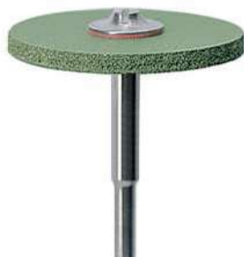
Codice: MOL.ALPHA.301 Nome: CERA GLOSS VERDE Misura: Ø mm.25 x spessore mm.2, Velocità 5000 giri/min.
