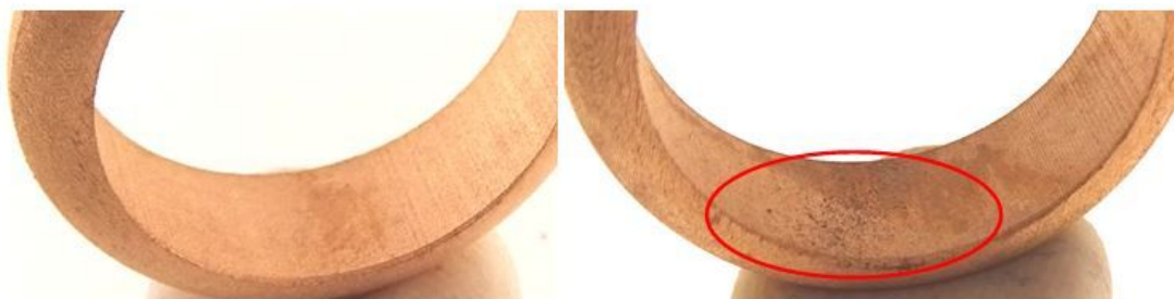
Figura 9 - porosità visibile su anello grezzo di fusione. A sx anello con alimentazione A e a dx anello con alimentazione B
