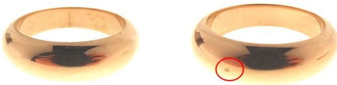
Figura 10 - evidenza di un poro macroscopico sulla superficie dell'anello con alimentazione B
