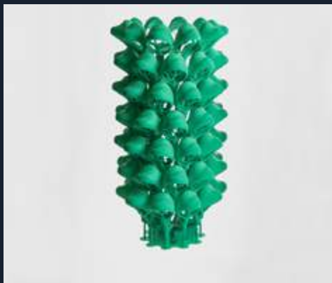
Albero di fusione stampato in 3D con il materiale Fusia Digital Wax
