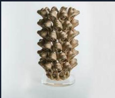
Risultato ottenuto tramite la microfusione a cera persa
